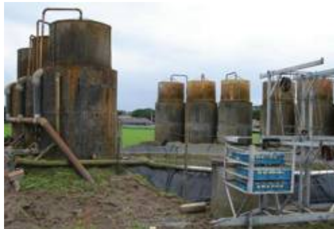
Particolare del sistema di riciclo e sterilizzazione biologica, con filtrazione lenta su sabbia, che permette il recupero dei sali lisciviati in una coltura di fragola a pieno campo.
