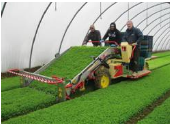
Anche le Fr 38 di De Pietri sono state dotate di un vaglio a scuotimento per una prima pulizia delle insalatine.
