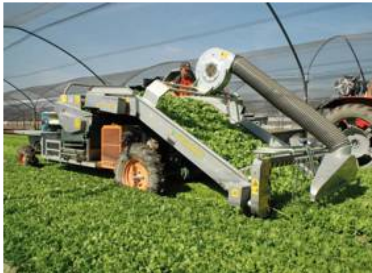
La Svk 8000 è la raccogliitrice con piano di selezione Selecta ideata dalla ditta veneziana Ortomec.
