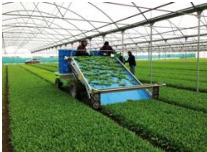
La Hortech ha realizzato la prima raccogliitrice per verdure a foglia ad azionamento elettrico. Con 14 ore di autonomia e 41 cavalli, è perfettamente adatta al lavoro sotto i tunnel.
