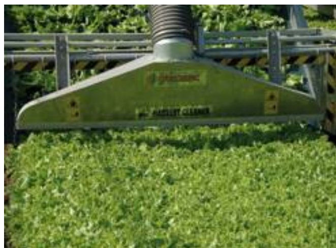
Un potente soffiatore scaccia gli insetti sulla Svk 8000 di Ortomec.
